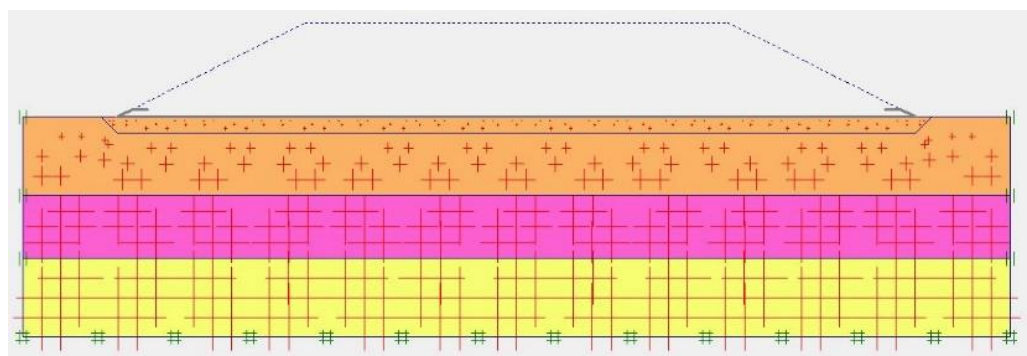
Gambar L-16.3 Initial Soil Stresses pada Lereng Timbunan 6m Replacement Dengan Perkuatan Masa Konstruksi
