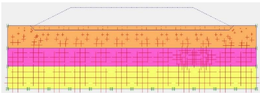
Gambar L-11.3 Initial Soil Stresses pada Lereng Timbunan 4m Tanah Asli Tanpa Perkuatan Masa Konstruksi
