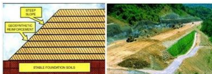
Gambar 3.8 Geotekstil Sebagai Perkuatan ( Reinforcement ) (Sumber: Isparmo, 2010)
