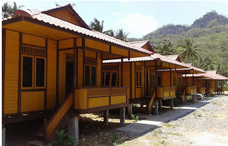
Gambar 2.7. Menunjukkan Aplikasi Desain Rumah Panggung di Queen of The South sebagai respon terhadap kelembaban dan curah hujan tinggi
