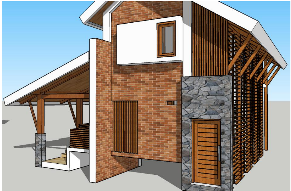
Gambar 3.21. Menunjukkan Desain Bangunan dengan Muka Lantai yang dinaikkan dan selubung bangunan yang dilapisi kisi-kisi ( Sumber : Penulis, 2017 )
