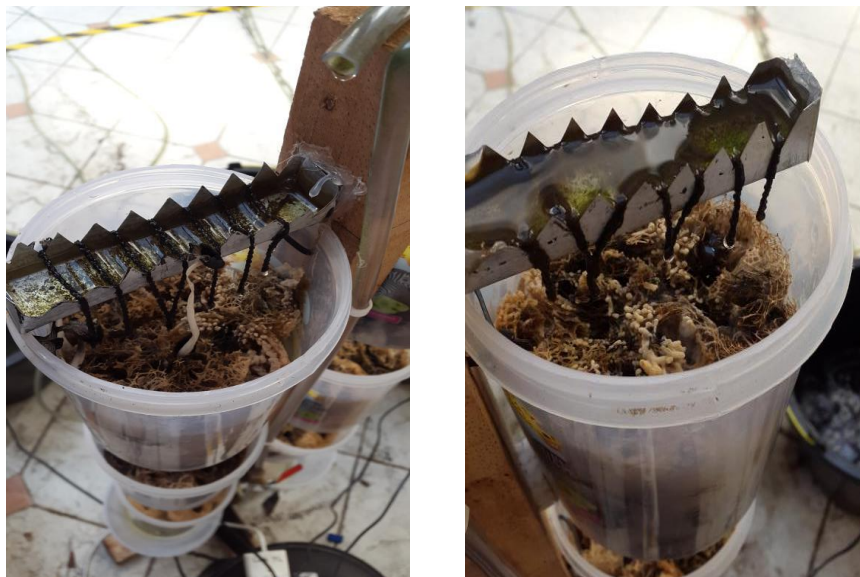
Gambar 4.4 Jamur pada Reaktor 1 dan Reaktor 2 Media Penyangga Luffa
