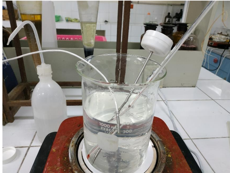
Gambar 1 Proses Pengujian Sensor Suhu
