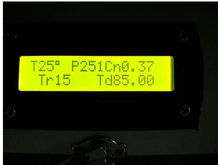
Gambar 12 Display Hasil Pengukuran Melalui LCD 2 x 16
