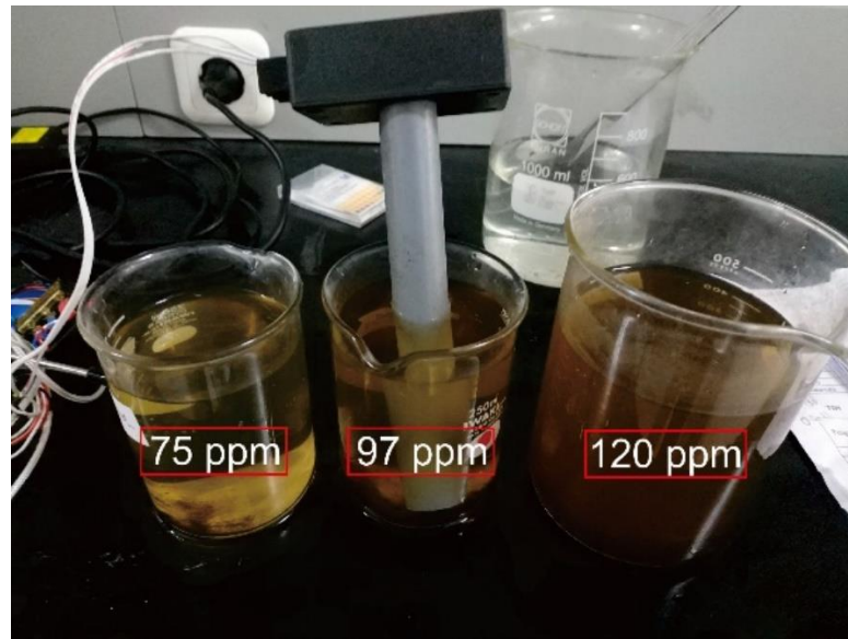
Gambar 8 Proses Pegujian Sensor TDS dan Konduktivitas
