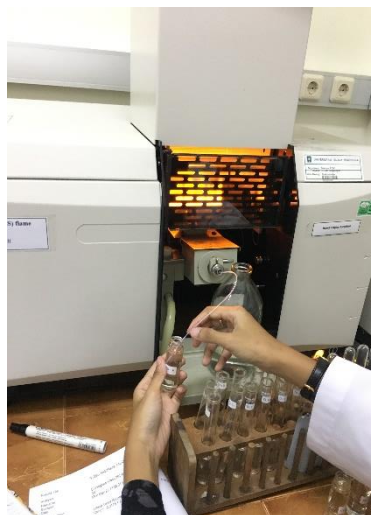
Gambar 4.4 Proses analisis timbal (pb) menggunakan spektrofotometer serapan atom (SSA) nyata.
