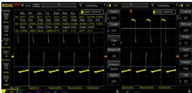
Gambar 10. *Output* PWM dengan *duty cycle* 30%
