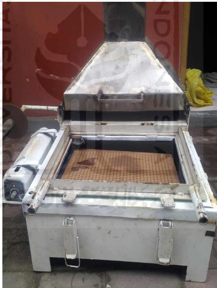
Gambar 4.1 Hasil Akhir Perancangan Shrink Packaging
