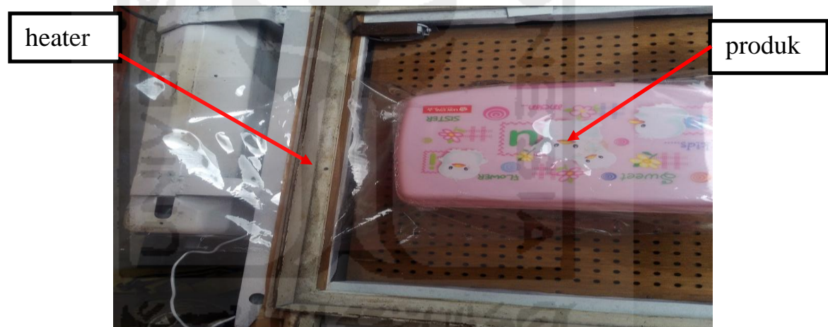
Gambar 3.10 Proses hot press ujung plastik.
