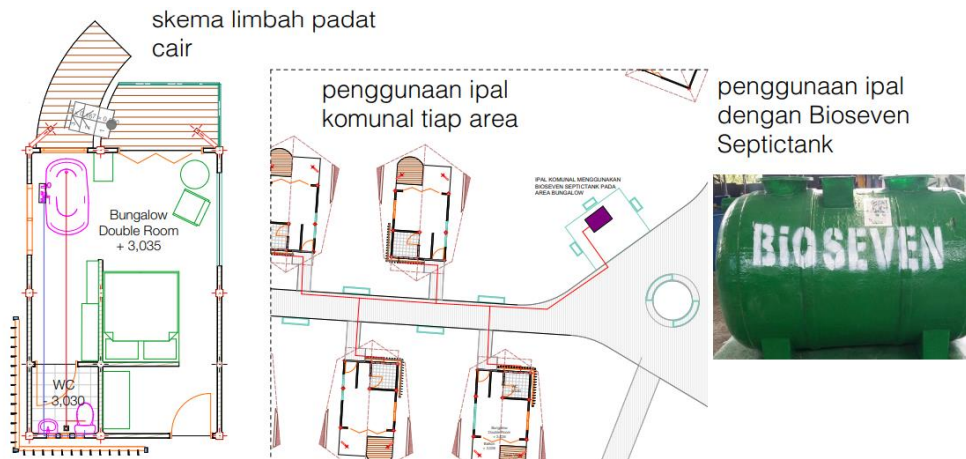
Gambar 1.68 Distribusi Air Kotor dan Penggunaan Bioseven Septictank Sumber: Penulis, 2018
