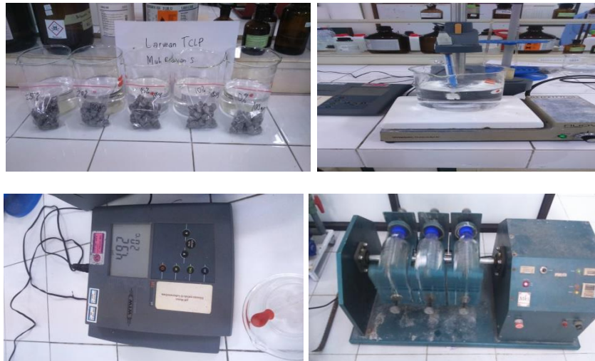
Gambar 3 Pengujian Lindi. Pengujian Lindi terhadap genteng beton pada awalnya membuat larutan ekstrasi, kemudian mengukur pH setiap variasi larutan ekstrasi. Selama 18 jam, larutan ekstrasi yang sudah bercampur dengan serbuk benda uji dimasukkan kedalam alat rotary agitator.
