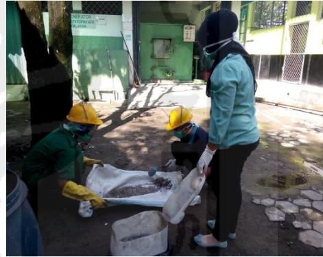
Pemilahan Abu Insinerator
