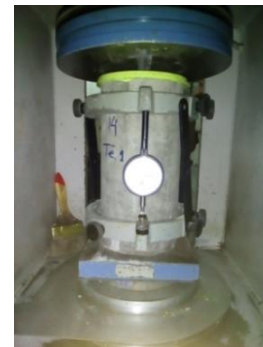
Gambar 9 Pengujian kuat tekan beton
