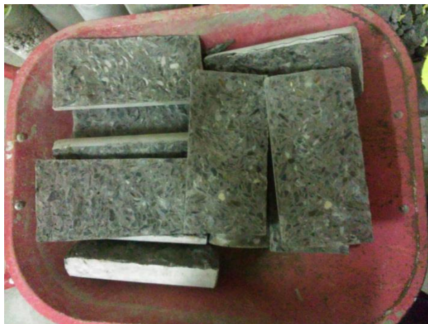
Gambar L.49.11. Proses pembuangan sampel silinder beton setelah melakukan pengujian kuat tarik/belah
