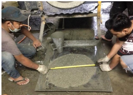
Gambar L.49.5. Proses mencari nilai slump-flow pada SCC
