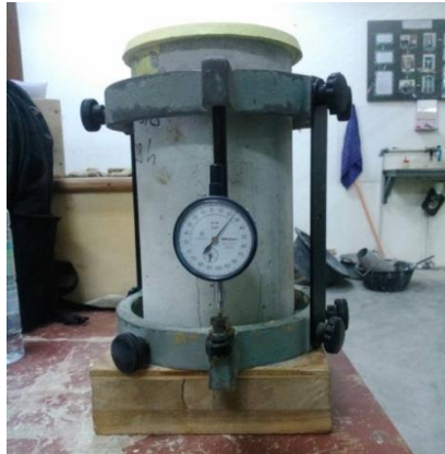
Gambar L.49.7. Sampel silinder beton setelah memasang alat untuk pengujian kuat tekan dan analisis modulus elastisitas
