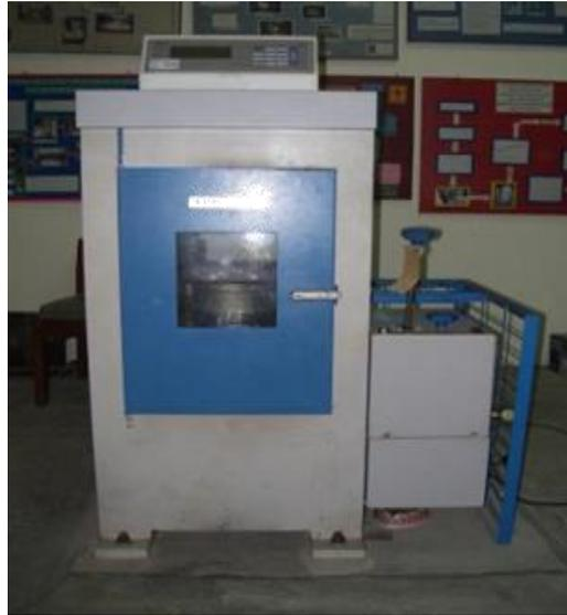
Gambar 4.9 Mesin uji desak tipe ADR 3000
