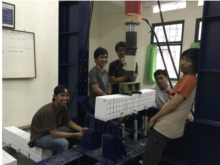
3. Set Up Pengujian Balok
