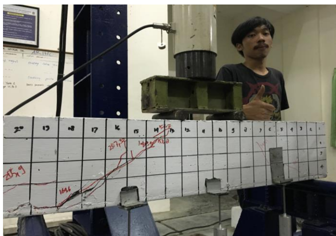
14. Pola Keretakan BP-2 Dengan Perkuatan (A)
