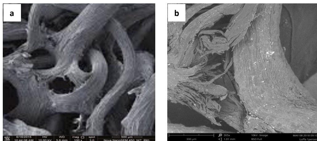
Gambar 4.5 Hasil SEM Spons Luffa Cylindrica Sebelum (a) dan Sesudah (b) Coating
