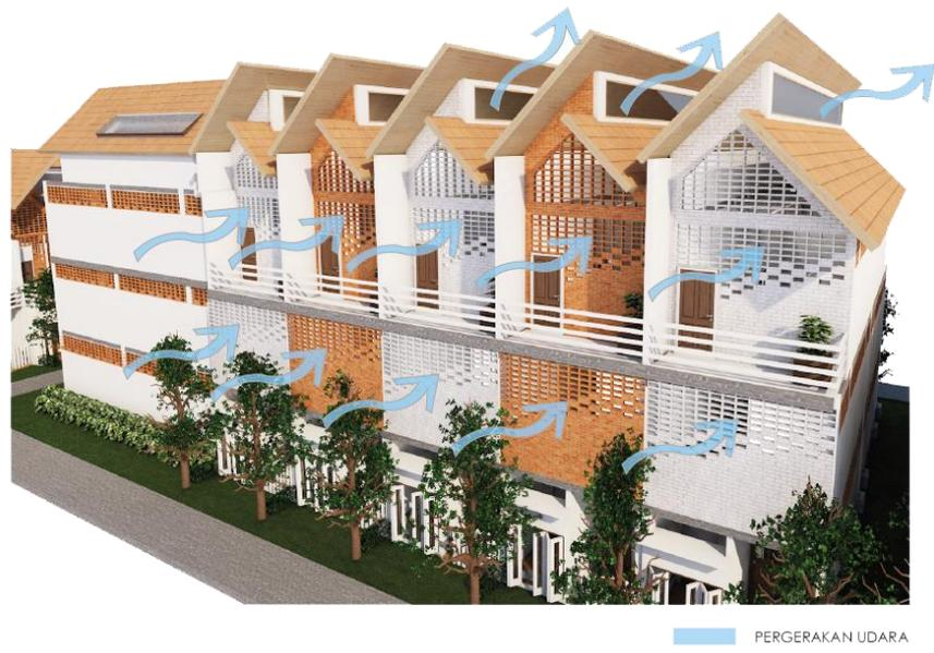
Gambar 5.3 Skema Penghawaan
