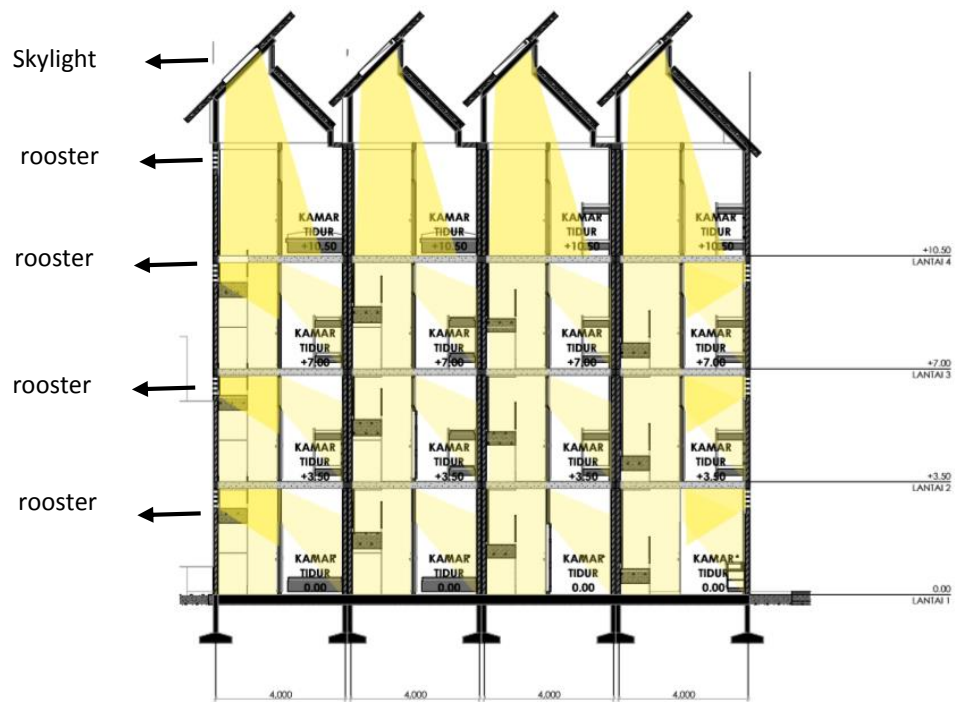
Gambar 4.6 Skema Pencahayaan Alami Hunian Deret Dusun Gowok
