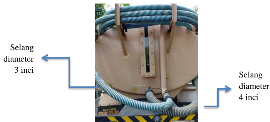
Gambar 4.3 Selang penyedot Lumpur Tinja Berdiameter 4 inci dan 3 inci milik Dinas PUPKP Kab.Bantul.
