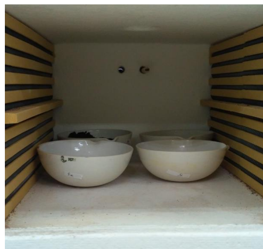
Untuk menguji kadar VS dalam sampel, sampel dimasukkan ke dalam furnace 600°C selama 2 jam.
