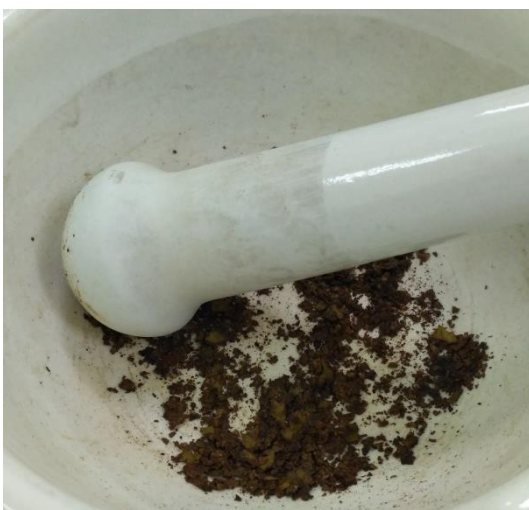
Sampel yang sudah dikeringkan kemudian digerus hingga halus untuk proses pengujian kadar TOC.
