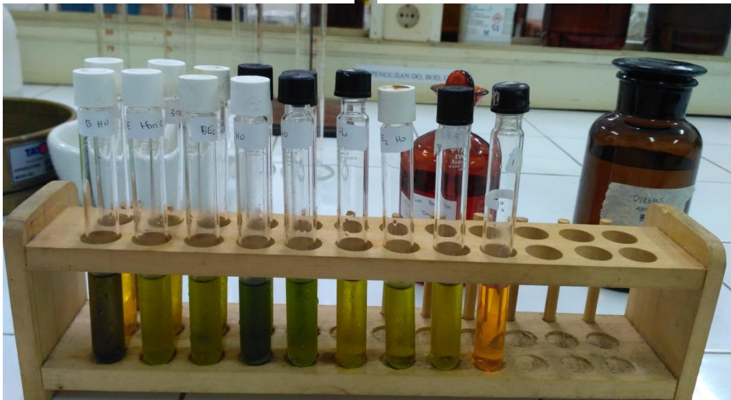
Pengujian Kadar COD metode spektrofotometri refluks tertutup. Warna sampel pada tabung refluks merepresentasikan kadar COD yang dikandung. Warna hijau pekat menandakan sampel memiliki kadar COD yang tinggi.
