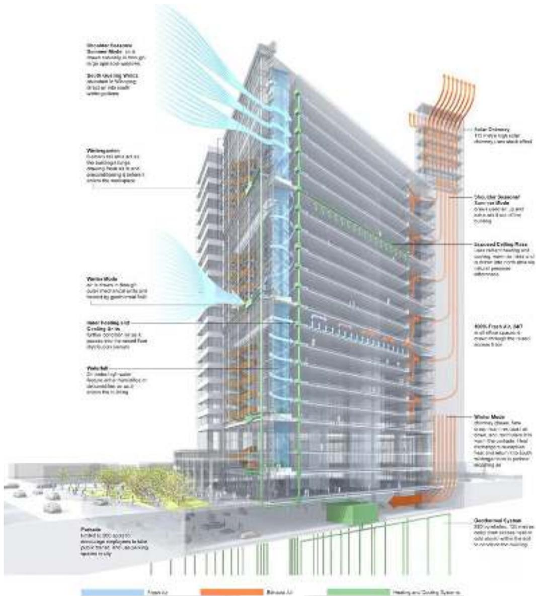
Gambar 2.38 Penerapan *Stack Ventilation* pada Bangunan Manitoba Hydro
