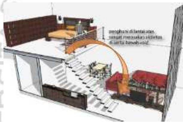
Gambar 2.27 Pengaruh *Void* pada Ketinggian *Ceilling* dan Interaksi Penghuni
