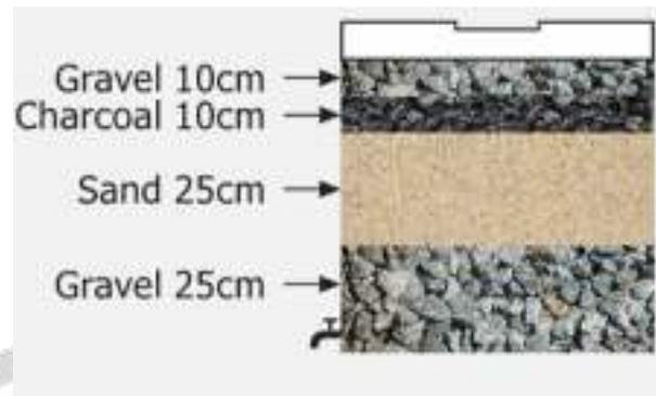
Gambar 2.51 Material Penyaring dalam Unit Filtrasi
