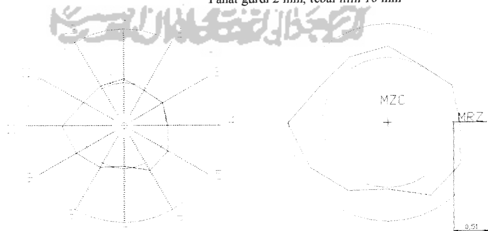
Gambar 4.16 Grafik kebulatan lingkaran 1 warna merah. Pahat gurdi 3 mm, tebal lilin 10 mm
