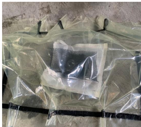
Gambar 3- 41 Susunan Serat Karbon, Peel Ply dan Kain Strimmin
