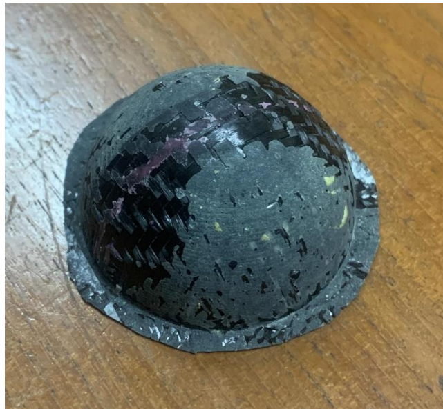
Gambar 4- 5 Hasil Produk Komposit dari Puzzle Mold
