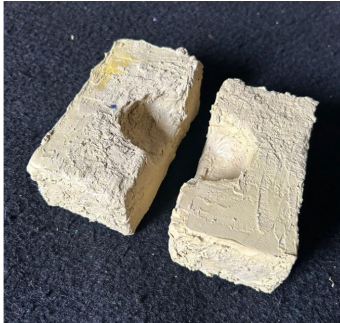
Gambar 4- 3 Hasil Pendempulan Polyester Putty pada Puzzle Mold
