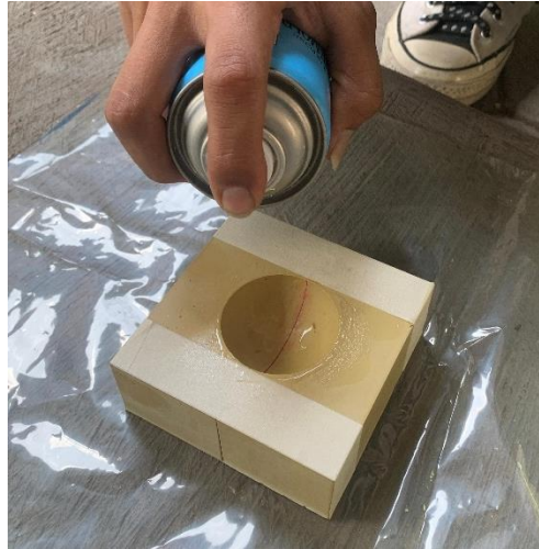
Gambar 3- 38 Penyemprotan Mold Release
