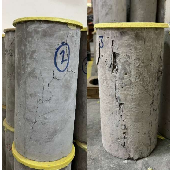
Gambar L. 7.6 Pola Keretakan Sampel Silinder
