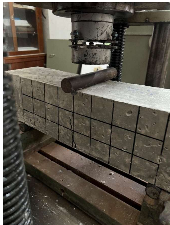
Gambar L. 7.7 Pengujian Kuat Lentur Beton
