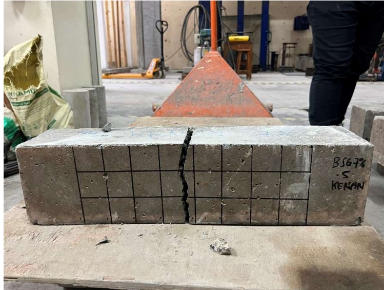
Gambar L. 7.8 Pola Keretakan Sampel Balok
