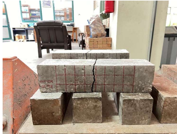
Gambar 5.15 Sampel Setelah Pengujian Kuat Lentur
