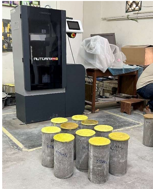
Gambar L. 7.4 Sampel Silinder Setelah Capping
