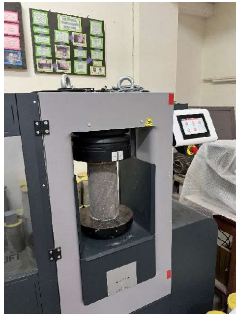
Gambar L. 7.5 Pengujian Kuat Tekan Beton
