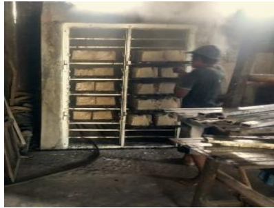
Gambar 4. 4 Pekerja Sedang Melakukan Proses Pengukusan
