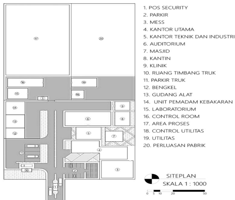
Gambar 4. 2 Layout Pabrik Dekstrin
