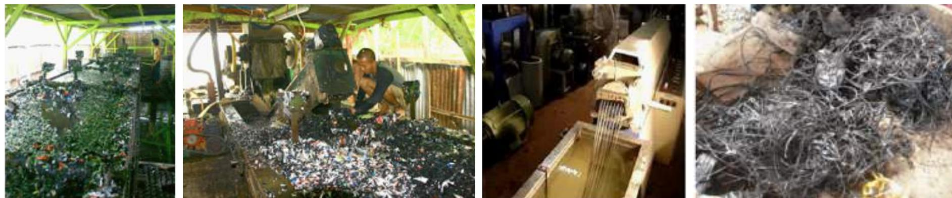
Gambar 24 : Proses pembuatan Rotan Sintetis
