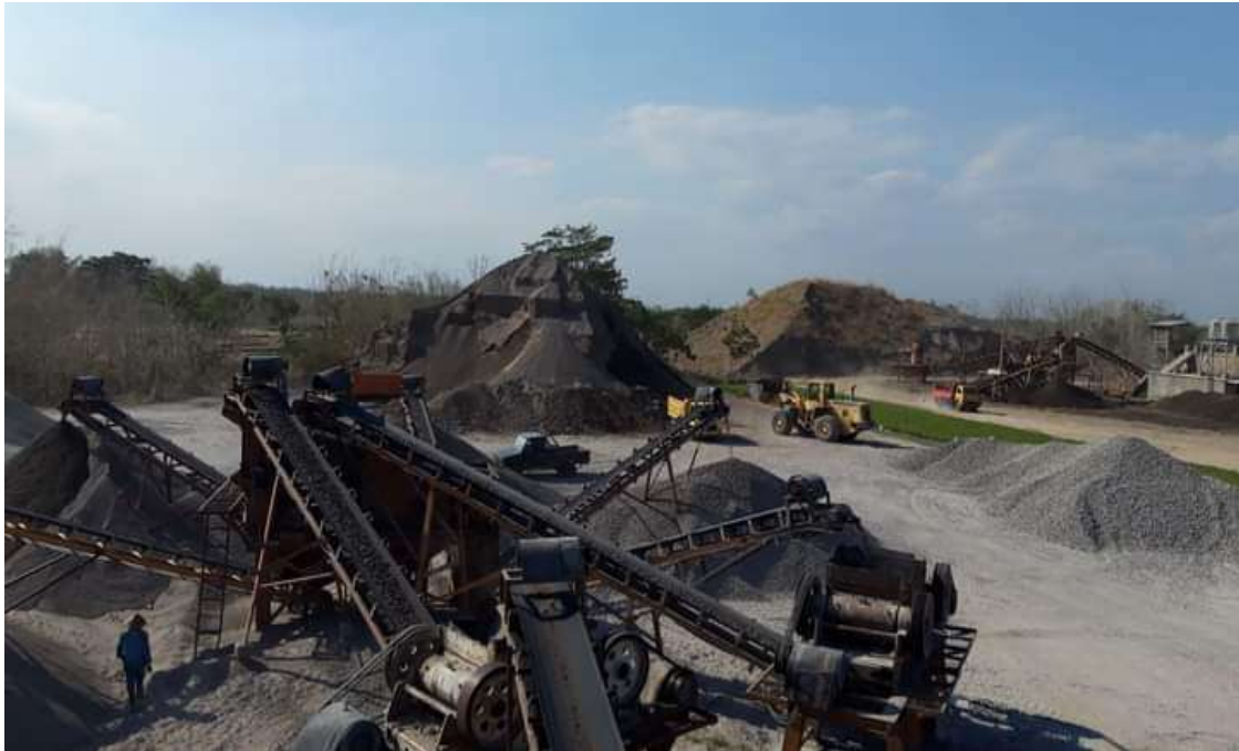
Alat pengklasifikasian batu split berdasarkan ukuran
