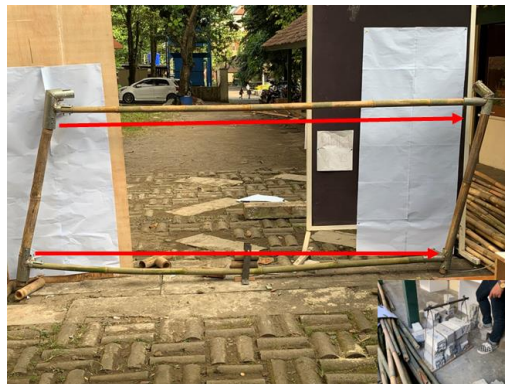
Gambar 6 Deformasi Modul Bambu
