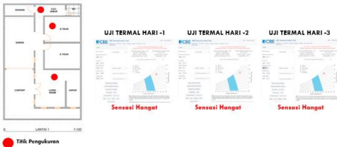
**Gambar 6** Hasil Pengukuran Termal Bangunan Eksisting
