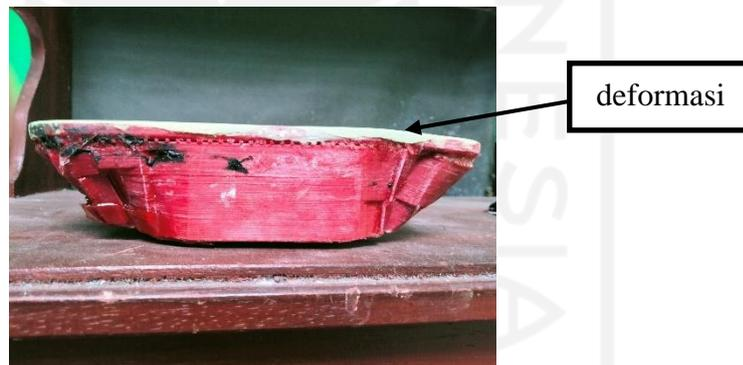
Gambar 4.28 Tampak depan hasil cetakan percobaan 4
