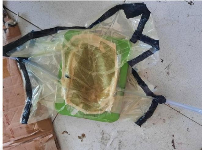
Gambar 4.17 Proses tes kebocoran pada *vacuum infusion*
