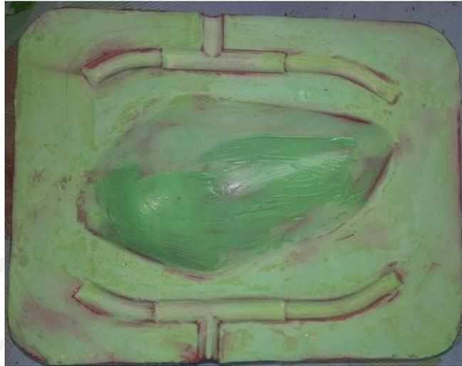
Gambar 4.15 Proses *finishing* menggunakan dempul
