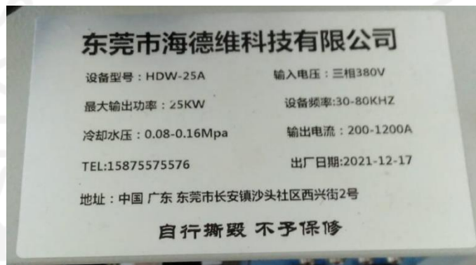
Gambar 4- 21 Spesifikasi Mesin Panas Induksi
