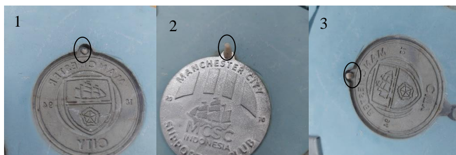
Gambar 4 - 36 Proses Penambalan Cetakan
