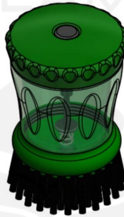
Gambar 4.1 Desain assembly produk sikat pencuci piring
