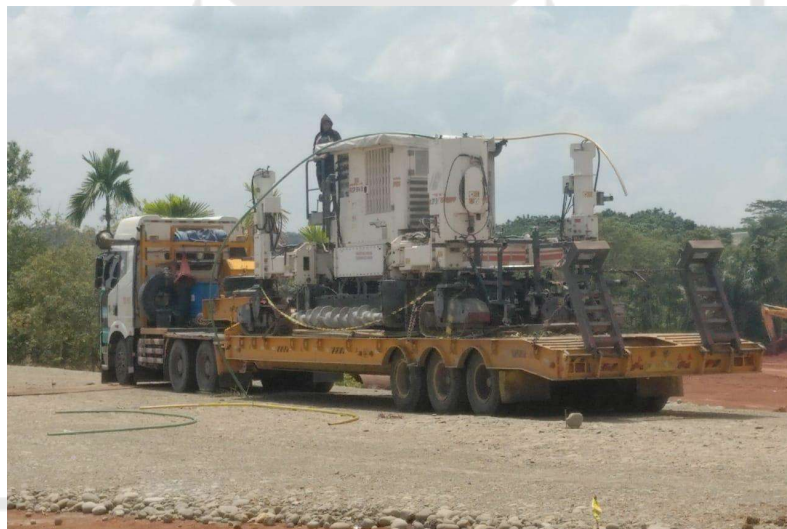
Gambar 77. Moving Alat Paver dengan Flat Bed Truck
