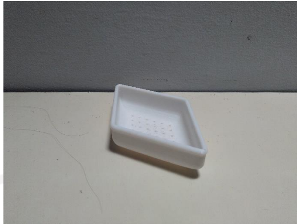
Gambar 4.3 Prototipe cetakan ketupat 1.0
