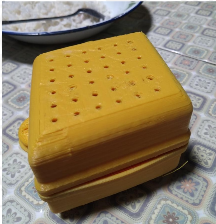
Gambar 4.67 Deformasi plastis pada prototipe cetakan ketupat
