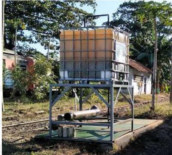
Gambar 12 Tangki / drum pengolahan minyak pada sumber pencemar 3
