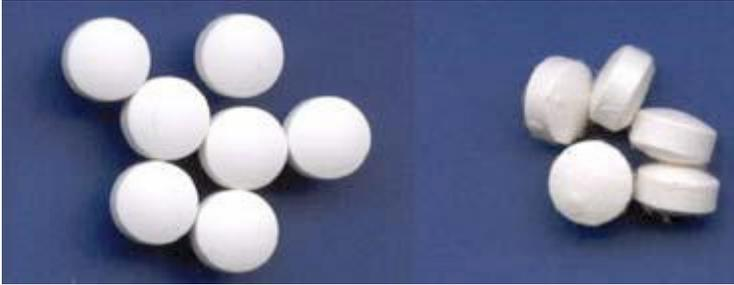
Gambar 6.20 Picking dan sticking pada tablet (sumber : [www.pharmainfo.net](http://www.pharmainfo.net))
