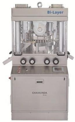
Gambar 6.17 Mesin cetak tablet 2 lapis (bi-layer) (sumber: <https://www.pinterest.se/pin/574068283726478208/>)
