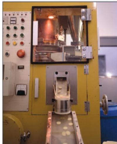
Gambar 7.1 Proses pencetakan tablet effervescent
