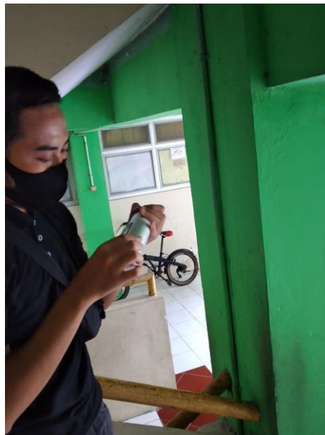
Gambar 5.11 Pembacaan Nilai Lenting pada Alat Palu Beton
