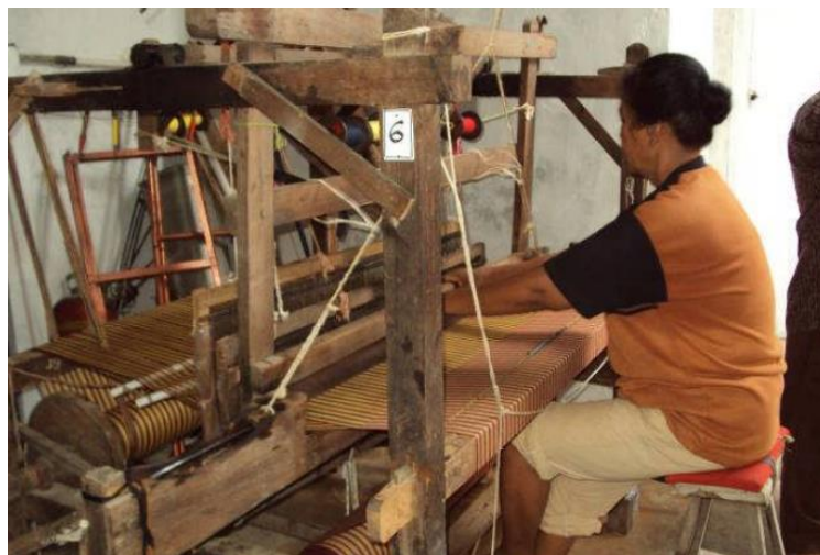
Gambar 2. 26 Proses Penenunan dengan ATBM
