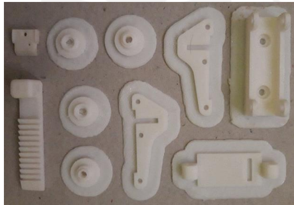
Gambar 4-45 Hasil 3D Print Sistem Pengunci
