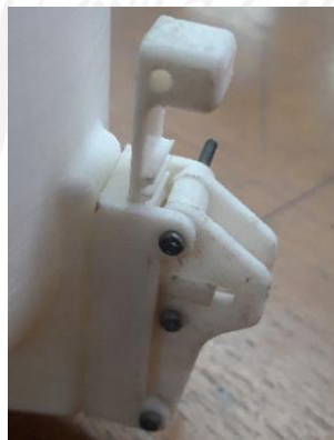
Gambar 4-46 Hasil Assembly Sistem Pengunci
