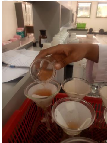
Gambar 3 Proses penyaringan air sampel menggunakan kertas saring. Kertas saring kemudian dikeringkan di dalam oven dan ditimbang beratnya. Kenaikan berat kertas saring sebelum dan sesudah digunakan, mewakili jumlah padatan tersuspensi di dalam sampel.
