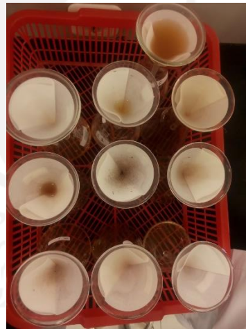
Gambar 3 Proses penyaringan air sampel menggunakan kertas saring. Kertas saring kemudian dikeringkan di dalam oven dan ditimbang beratnya. Kenaikan berat kertas saring sebelum dan sesudah digunakan, mewakili jumlah padatan tersuspensi di dalam sampel.
