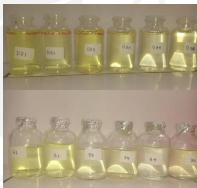
Gambar 4 Proses pendestruksian logam dalam sampel dengan menggunakan larutan \text{HNO}_3 pekat di dalam lemari asam. Proses destruksi ini bertujuan untuk memutus ikatan logam didalam sampel menjadi zat-zat anorganik bebas. \text{HNO}_3 merupakan oksidator yang kuat yang dapat melarutkan logam di dalam sampel dan mencegah pengendapan.
