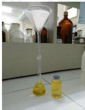
Gambar 4 Proses pendestruksian logam dalam sampel dengan menggunakan larutan \text{HNO}_3 pekat di dalam lemari asam. Proses destruksi ini bertujuan untuk memutus ikatan logam didalam sampel menjadi zat-zat anorganik bebas. \text{HNO}_3 merupakan oksidator yang kuat yang dapat melarutkan logam di dalam sampel dan mencegah pengendapan.
