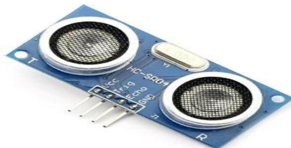
Gambar 2.3. Bentuk Fisik Sensor Ultrasonik HC-SR04
