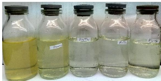
Hasil pengolahan limbah laboratorium kimia melalui proses elektroflotasi-biokoagulasi menggunakan kombinasi biokoagulan
