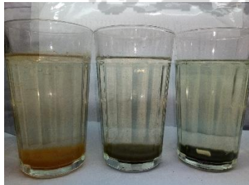
Hasil pengolahan limbah laboratorium kimia proses biokoagulasi
