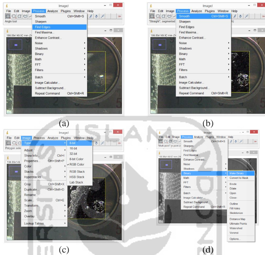
Gambar 8. Proses memperjelas visualisasi citra dengan perintah find edges (a) smooth (b) 8-bit (c) dan Binary (d)
