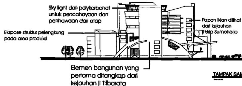
Pada fasad terlihat enternace yang didominasi rangka baja dan struktur tali dengan elemen fasadnya yang masih dikontraskan dengan elemen disekitarnya, elemen transparan mendominasi area perkantoran dan di area produksi dengan ekspose rangka struktur bentang lebar. Semua itu diambil dari pendekatan high tech architecture
