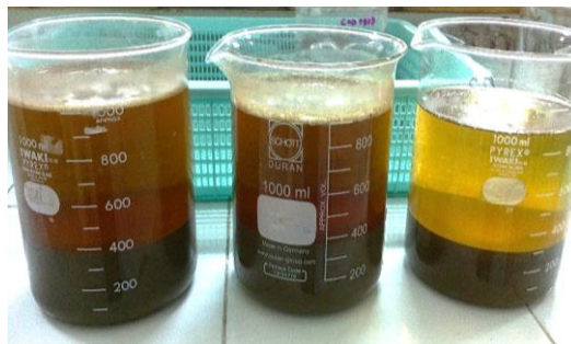
Gambar 3.3 Proses Aktivasi Dengan Asam Fosfat 1M (Sumber: Data primer, 2016)
